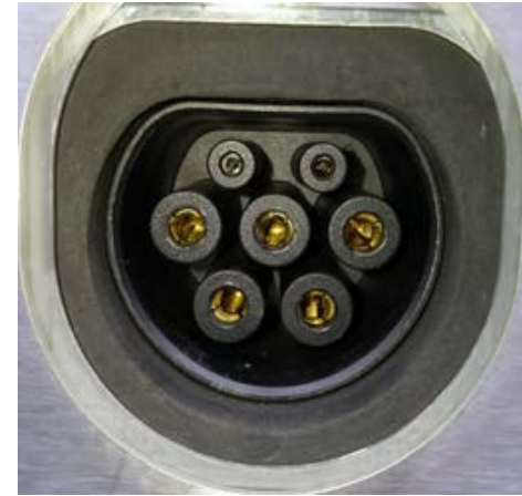
Tyyppin 2 (Type 2) pistorasia Kuvan lähde: SESKO lataussuositus 2019
